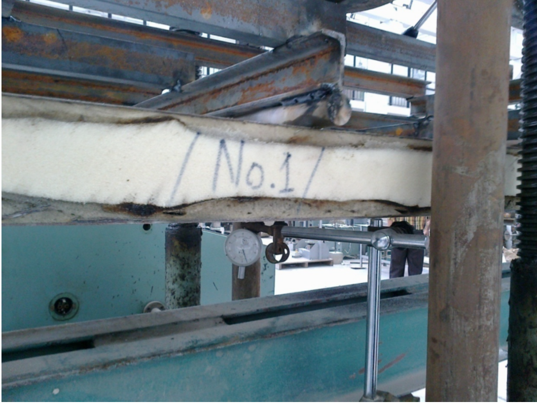
الشكل (3-5) العينة 1 عند تطبيق الحمولة عليها مع إظهار جهاز القياس
