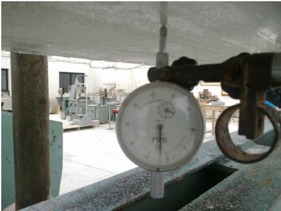
الشكل (3-3) ساعة القياس المستخدمة لقياس السهوم في العينات
