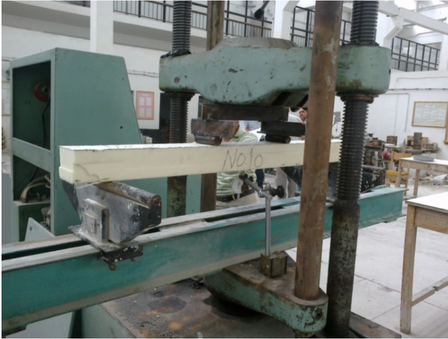
الشكل (15-3) تطبيق الحمولة مع عرض جهاز نقل الحمولة
