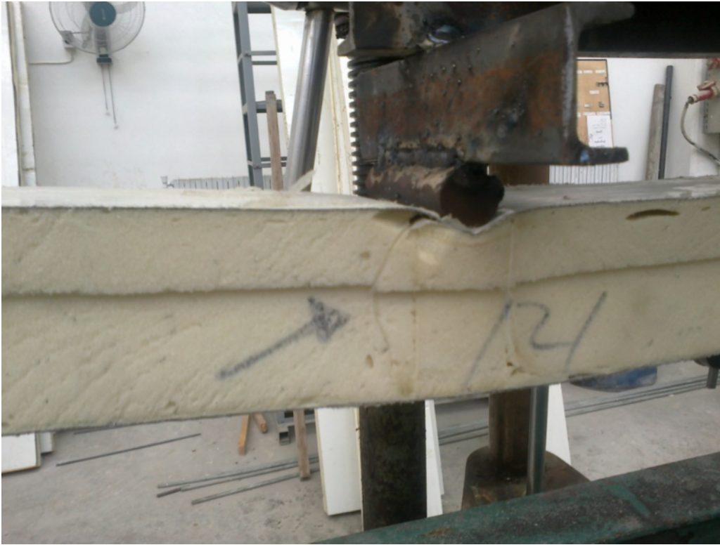
الشكل (3-18): صورة العينة رقم (2) التثوه الموضعي الحاصل عند حدوث الانهيار مع إظهار انفصال مادة النواة عن بعضها
