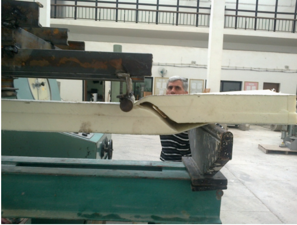
صورة العينة رقم 5: انهيار العينة على القص
